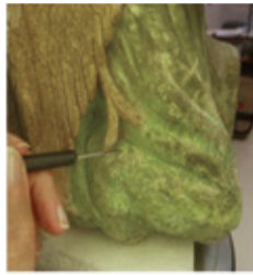
M3: Es veu amb l'observació en detall de l'àrea que sobre la terracota de fons gris hi ha una primera capa groga (zona A) i, sobre aquesta, una capa verda superficials A2 i A1 de la mostra M3.
